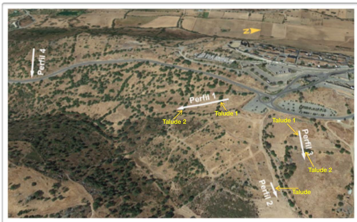
**Figura 1-** Imagem satélite do Google Earth com implantação dos dos perfis de GPR (200MHz e 400MHz) e Magnetometria executados
