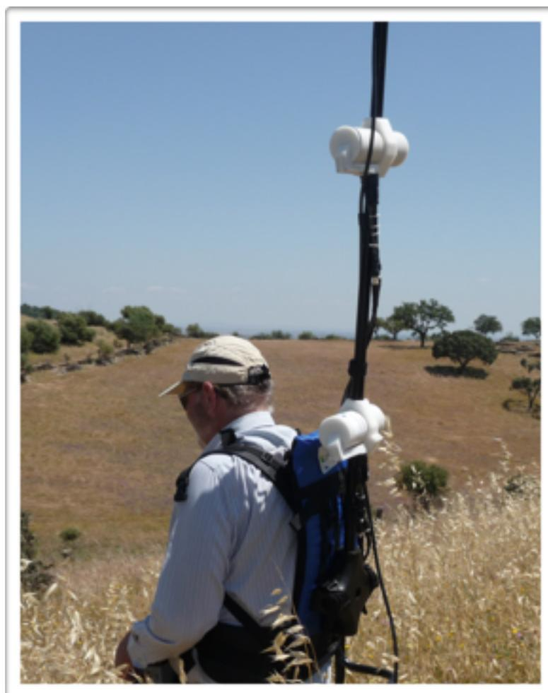
**Figura 3-** Levantamento de um perfil de magnética.
