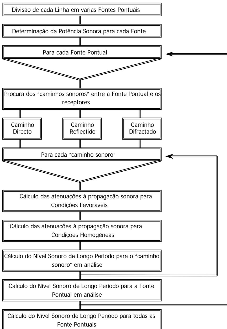
Figura 4-2 – Fluxograma do método NMPB'96.
