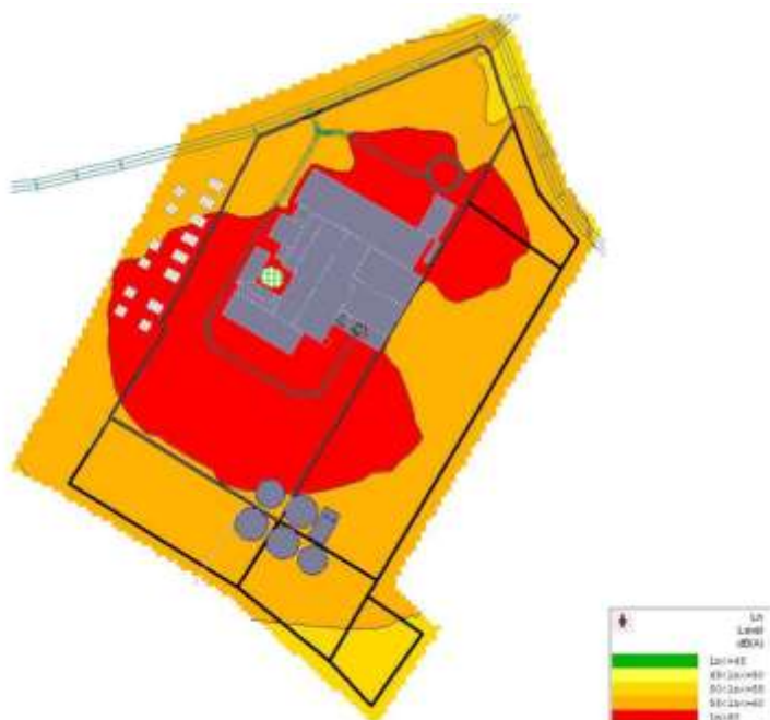
Figura 4.2.9 - Mapa do Ruído da fase de funcionamento do projeto no período noturno.
